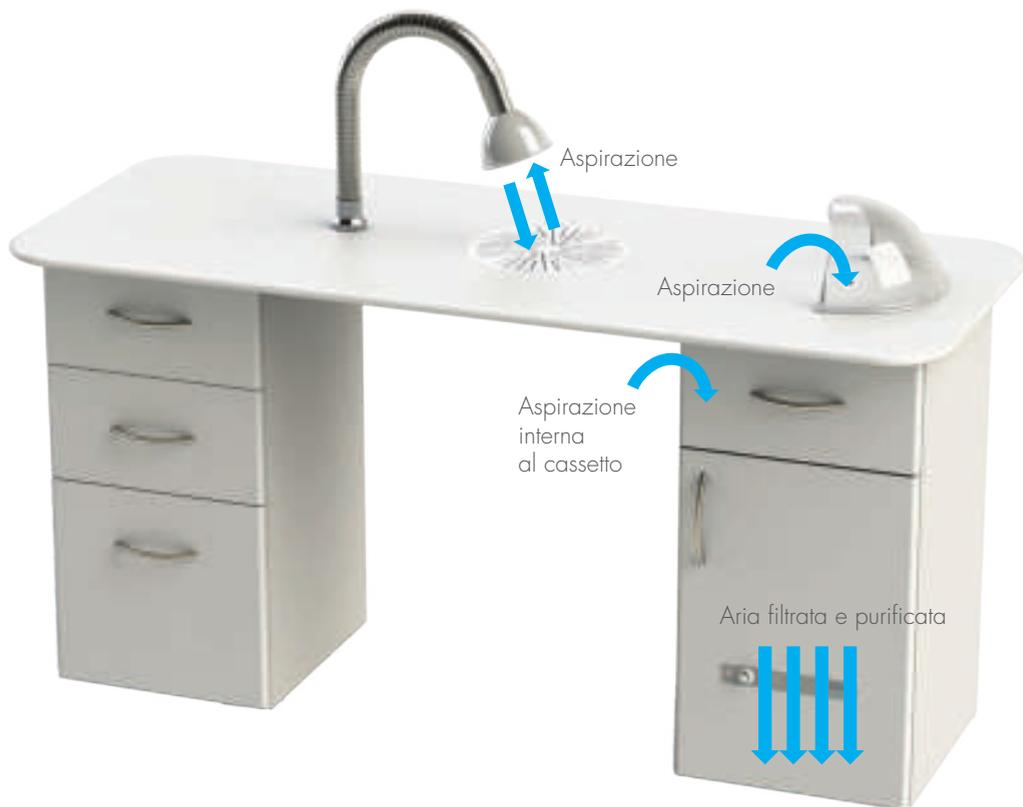
I vapori dei solventi, i fumi dei prodotti chimici e la polvere delle unghie vengono aspirati e catturati, per essere trascinati fino al sistema a doppio filtro, sia verso l'alto, attraverso il braccio regolabile, sia verso il basso attraverso la griglia posta sul piano di lavoro, ma anche attraverso una cupola dove riporre i contenitori aperti che possano rilasciare fumi e vapori nell'aria, e dal retro del cassetto per evitare che vengano rilasciati quando questo viene aperto.
