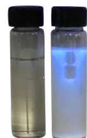
EC-Bouillon: Linke Ampulle: Kontrolle; rechte Ampulle: Mit Escherichia coli ATCC 25922 geimpfte Bouillon
