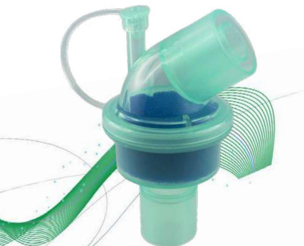
Le HME de GVS agit d'une façon similaire aux voies aériennes supérieures d'une personne. Lors de l'expiration, le média capture et retient l'humidité et la chaleur contenues dans l'air expiré qui, autrement, seraient perdues. À la respiration suivante, l'humidité et la chaleur sont libérées pour chauffer et pour humidifier le gaz inspiré.
